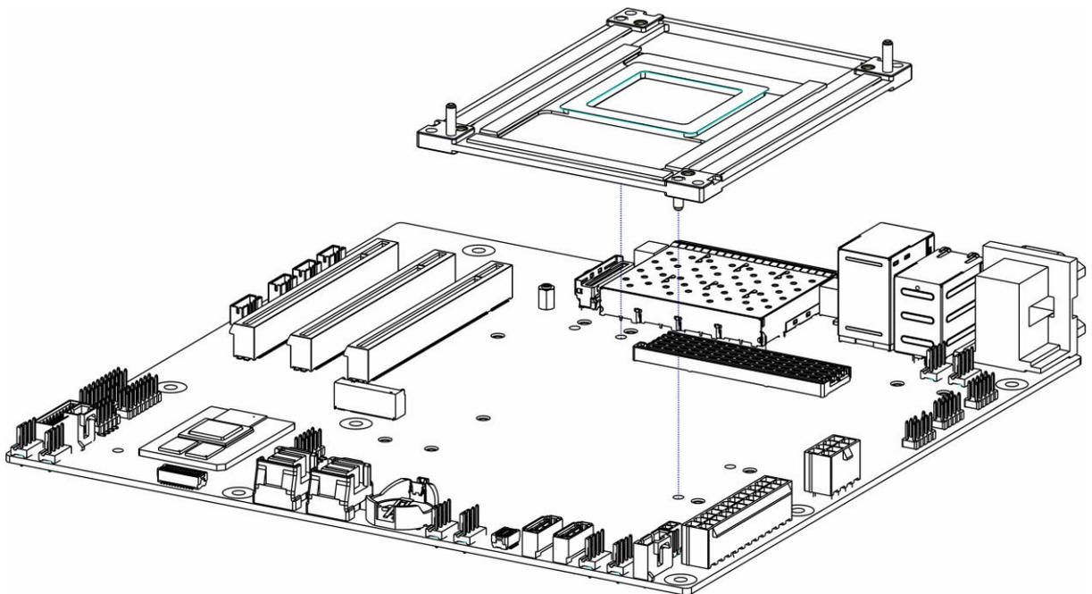
2-1.将 KP920S CPU 模组调整好位置,使 2 个定位孔和连接器与 KP920S 模组下支架组件上的 2 个定位销钉和主板上的连接器对准,将 CPU 模组缓慢按压插入到主板上;
