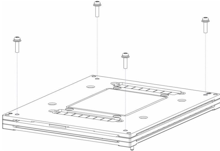
3-1.将前面步骤安装好的模组调整好位置，使 2 个导向销钉和连接器与主板上的 2 个定位孔和连接器对准，将模组缓慢按压插入到主板上，注意检查连接器位置确保扣合到位，可在连接器位置处多按压 2 次。
